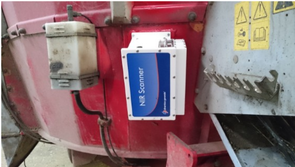
NIR apparat fra Dinamica Generale, Italien monteret på 45m 3 JF foderblander (nuværende Kongskilde Agriculture). Afskærmningen af NIR apparatet er ikke vist på billedet. NIR apparatet styres via vejecomputer i traktorens førerhus. Foto Niels Bastian Kristensen, SEGES.
